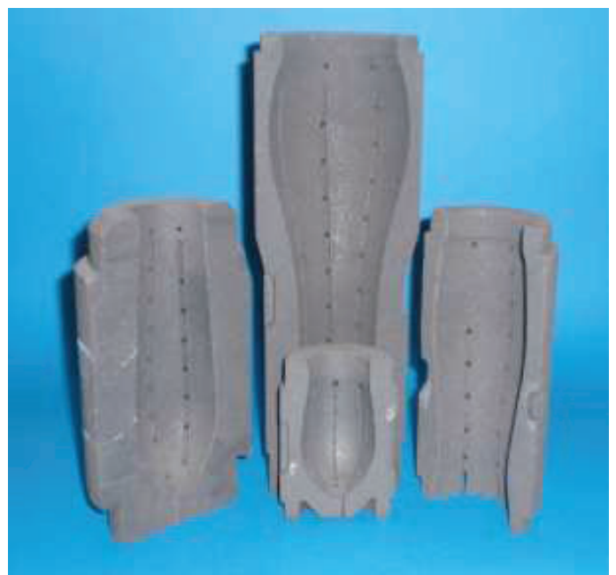
Poröse Hartkohle: Blasformen für Automatenproduktion Porous hard carbon: blow moulds in automatic production
